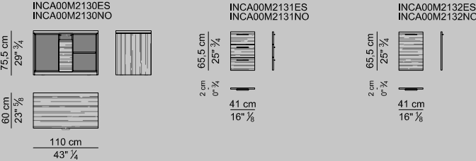
MOBILI DI SERVIZIO CON PIANO SOLLEVABILE ELETTRICAMENTE IN ESSENZA O MELAMINICO - ELECTRICALLY LIFTABLE VENEER OR MELAMINE TOP SERVICE CABINET
